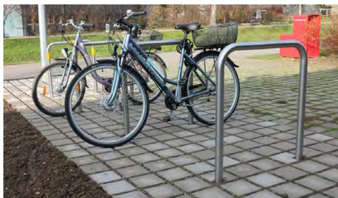
Le système avec arceau permettant d'attacher le cadre et la roue avant à un point fixe est flexible en termes d'espacement (0,50 à 2,00m) et s'adapte à tous types de vélos spéciaux (vélo cargo, charrette) (image: AggloY)
